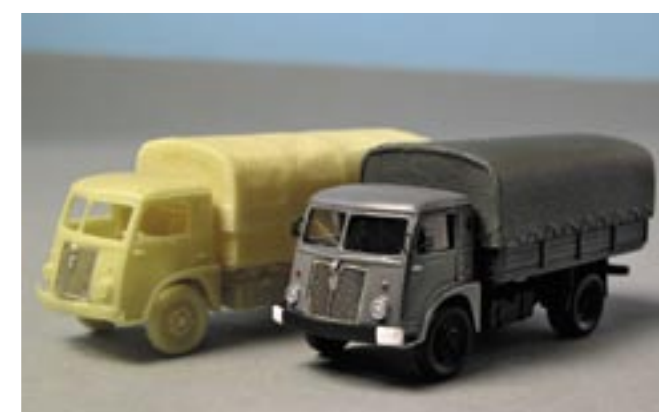
Star 25 ma pięknie odtworzoną atrapę chłodnicy wykonaną w technice fototrawienia. Tak powstają także lusterka i wycieraczki
