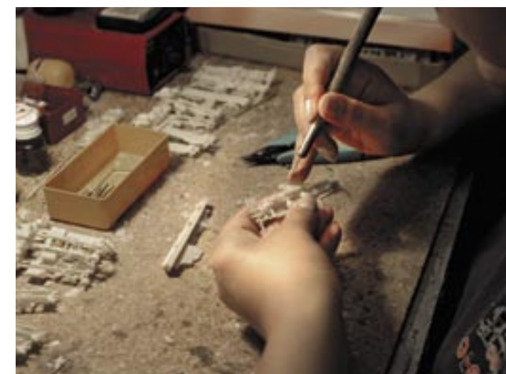
Po wyjęciu z form poszczególne elementy modeli wykonane z żywicy muszą zostać precyzyjnie oczyszczone z nadlewki i wyrównane
