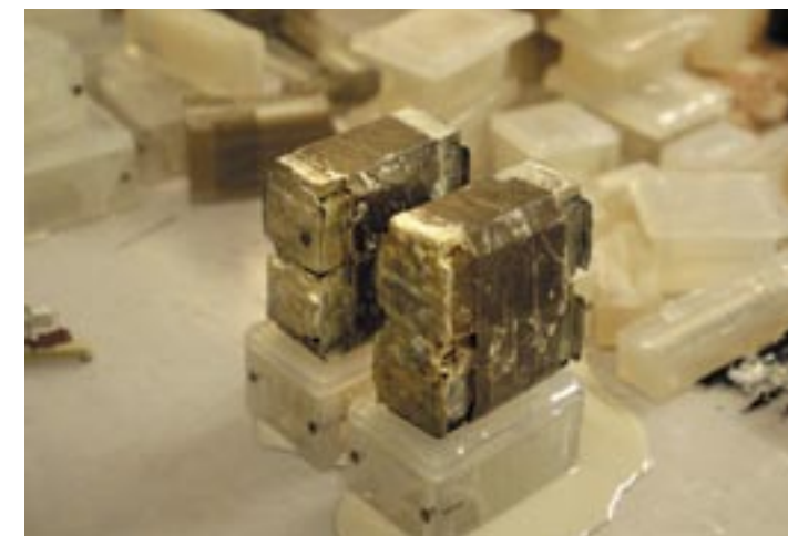
Ze względu na szybkie zużycie formy do elementów z żywicy trzeba wykonywać od nowa po „odlaniu” zaledwie dwudziestu modeli
